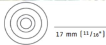
Poulie ringot inox A4 pour hale-bas (Tension câbles transversaux)
